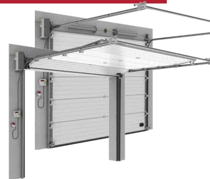
Le système de coulissage standard est utilisé quand la retombée du linteau (Hb) fait 280mm minimum (pour la porte manuelle) et 320mm minimum (pour les portes motorisés ou actionnés à l'aide d'une chaîne).
