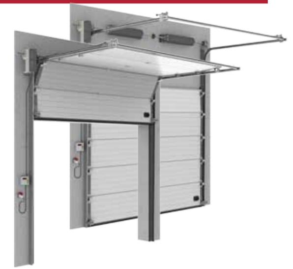
Le système avec rehaussement vertical partiel est la solution optimale pour une utilisation efficace de l'espace dans la zone industrielle dans les cas de grande retombée de linteau. L'espace minimum requis pour l'installation des ressorts (M) et de 420mm.
